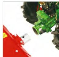
Rohrbaufansch: einfacher und schneller Anbaugerätewechsel
